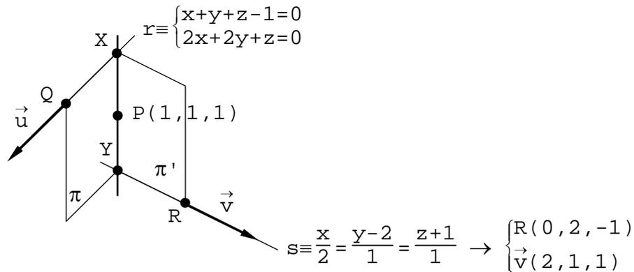
El calculo<sup>1</sup> de las ecuaciones paramétricas de la recta  $r$  permite hallar un punto,  $Q(-1,0,2)$ , y un vector direccional,  $\vec{u}(-1,1,0)$ .
