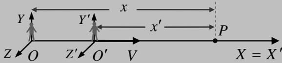
Probemos que la ecuación (1.11) no es invariante ante una transformación de Galileo. El conjunto de ecuaciones que relacionan las coordenadas espaciales y el tiempo medidos por los dos observadores inerciales  $O$  y  $O'$  de la figura ( $O'$  se mueve respecto a  $O$  con una velocidad  $V$  a lo largo del eje  $OX$  común a ambos sistemas de coordenadas), son,
