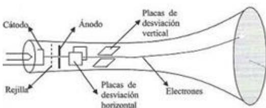
Hasta hace poco tiempo multitud de dispositivos electrónicos, tanto en productos de consumo (televisión) como en instrumentos científicos (osciloscopios) estaban basados en el *tubo de rayos catódicos*, como el ilustrado en la figura. En este tubo se ha hecho el vacío y uno de sus extremos posee un *cañón de electrones* (filamento metálico que, al calentarse, emite estas partículas, las cuales pueden ser sepa-
