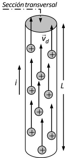
mo la cantidad de carga que pasa por una sección transversal del mismo por unidad de tiempo. Si la cantidad de carga ( $\Delta q$ ) que pasa por la sección del conductor es directamente proporcional al tiempo ( $\Delta t$ ), la intensidad, que es constante, se obtiene dividiendo la carga entre el tiempo; esto es,
