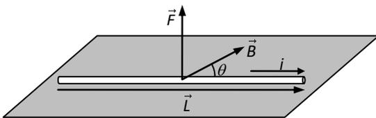
Sea un conductor rectilíneo, por el que circula una intensidad constante  $i$ , en el interior de un campo magnético uniforme de intensidad  $\vec{B}$ , como ilustra la figura. Si la velocidad media de las cargas que se mueven en el interior del conductor es  $\vec{v}_d$ , la longitud del mismo  $L$  y la carga total en movimiento  $\Delta q$ <sup>7</sup>, la intensidad de la fuerza que el campo ejerce sobre el conductor es,
