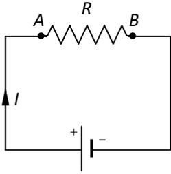
Sea el circuito de **corriente continua cerrado** mostrado en la figura. Si  $dW_A^B$  representa el trabajo<sup>3</sup> infinitesimal realizado por el campo eléctrico cuando una cantidad de carga  $dq$  (infinitesimal) entra en  $R$  por el punto  $A$  y sale por el  $B$ <sup>4</sup>, tenemos que,
